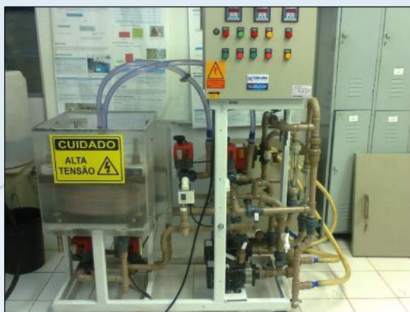
Figura 2. Sistema piloto de eletrodialise (EDR 0,25 -100 1E 1s 1e, Hidrodex) Fonte: Laboratório de Tratamento de Efluentes – Feevale.
